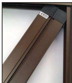
**fare attenzione** ad inserire il pacchetto della zanzariera (fig. 4) con il lato che riporta l'etichetta CE sempre verso l'alto e verso l'interno , (quindi aprendo la zanzariera , l'etichetta si muovera' ). Applicare le manigliette con una chiave a brugola da 2mm (non in dotazione) e aprire la zanzariera per la prova di funzionamento -
